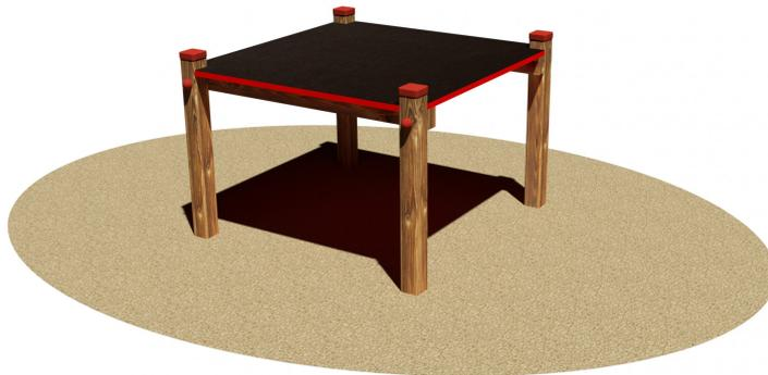
Realizzato in legno di pino nordico impregnato in autoclave con sali atossici. Costituita da n° 1 pedana in multistrato di betulla ad incollaggio fenolico, con zigrinatura antiscivolo, e rifinitura con film colorati in entrambi i lati. Posizionata ad altezza di cm 65 mediante n° 4 montanti in legno di pino lamellare della sez. cm 7 x 7. Assemblaggio mediante bulloneria in acciaio zincato 8.8 e dadi autobloccanti. Elementi copridado a norma in nylon colorato. Tappi copripalo in polietilene.
