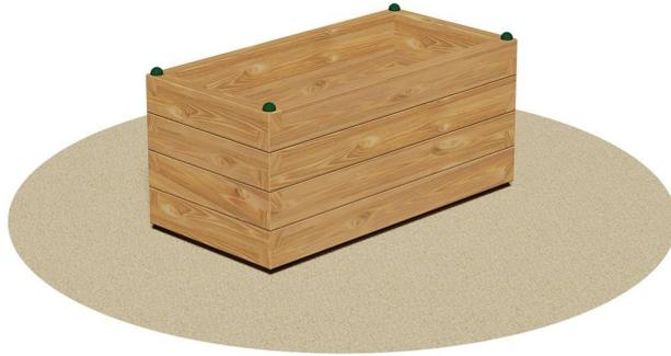
Fioriera arredo urbano in legno Modula. Realizzata interamente con fasce in legno di pino nordico impregnato in autoclave della sez. cm 11 x 4,5 e base in multistrato di betulla ad incollaggio fenolico con film colorati in entrambi i lati dello spessore di cm 1,9. Il tutto assemblato con bulloneria in acciaio zincata. La fioriera viene fornita al Cliente in kit di montaggio. Ingombro max: cm 50x100x50 h
